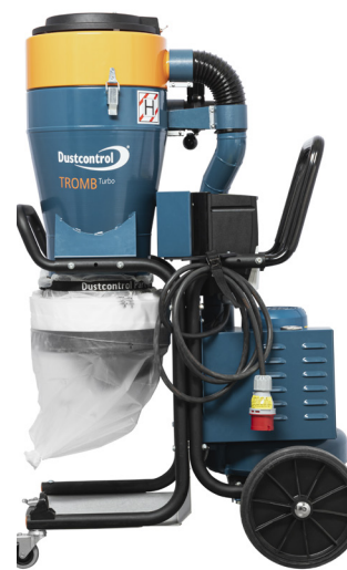
DC Tromb Turbo med VFD (Växelomvandlare)
