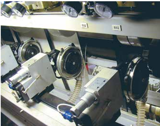
Sugkåpa monterad på skärkniv i tryckpressen
